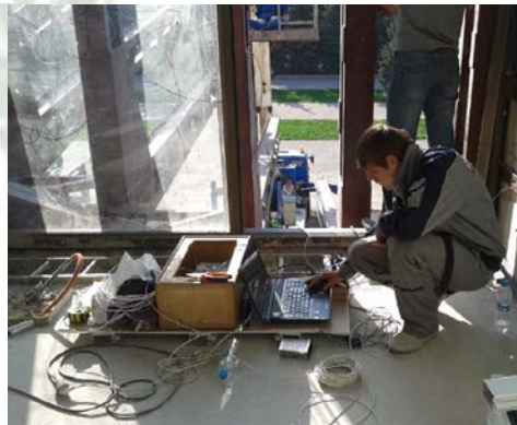
Мал. 4. Реєстрація вібрації а),б)розміщення вібромашин в фермах, в) встановлення п'єзоелектричних перетворювачів, г) реєстрація вібрацій
