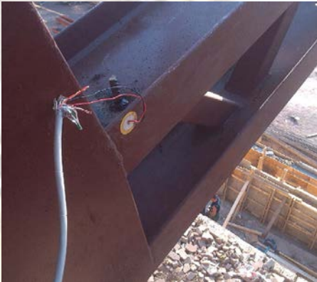
Мал. 4. Реєстрація вібрації а),б)розміщення вібромашин в фермах, в) встановлення п'єзоелектричних перетворювачів, г) реєстрація вібрацій
